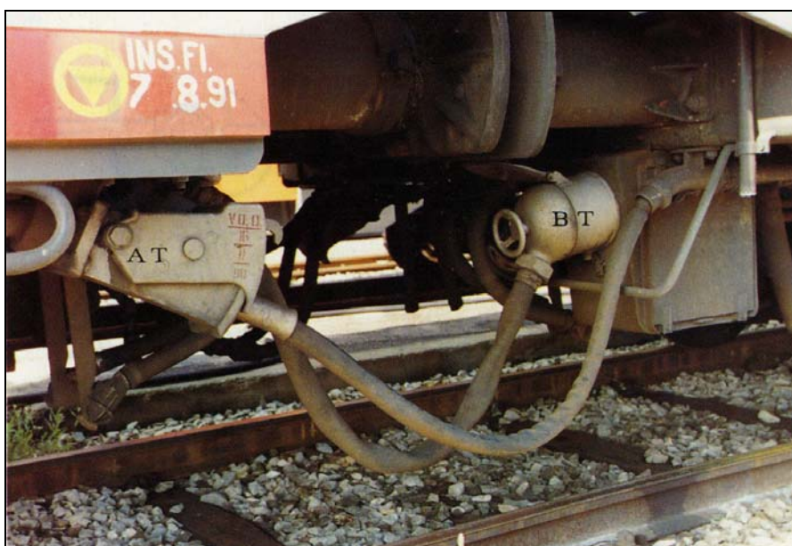
Figura 4 Condotte ad alta tensione e a bassa tensione.
