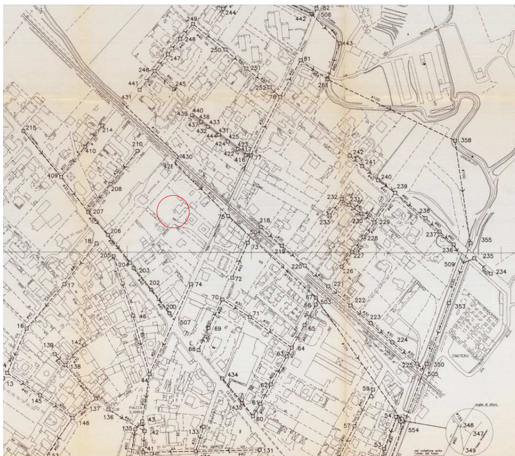
Figura 11 – Schema della rete – Estratto da “carta della rete fognaria esistente”, Comune di Locate V.
