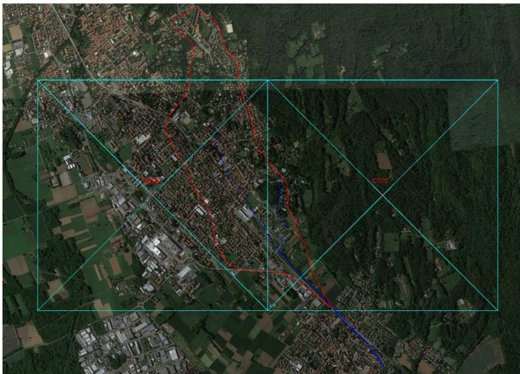
Figura 2 – Celle di calcolo dei parametri di possibilità pluviometrica per il bacino del Fosso Re.
