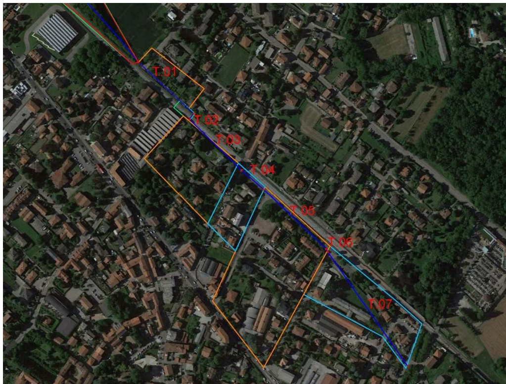
Figura 12 – Schema della rete con le sigle dei tronchi di calcolo e aree scolanti.
