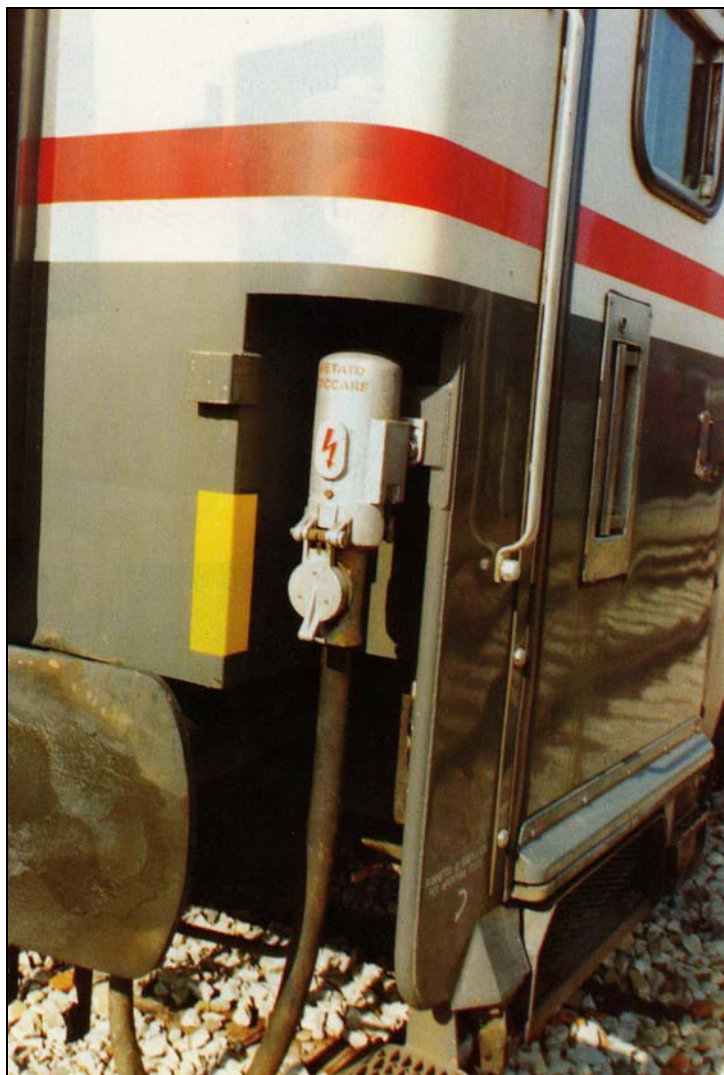
Figura 5 Condotta ad alta tensione in posizione di riposo.
