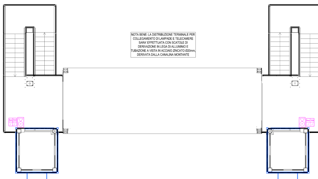
Figura 47 – Estratto impianto tvcc planimetria piano ammezzato
